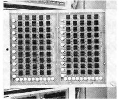
Kondensatorplatte auf Rückseite der Zählerbucht
