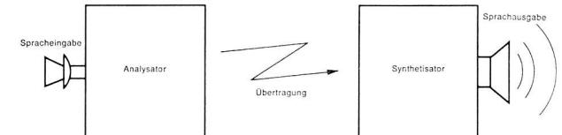
Vocoder ist die Abkürzung für Voice Coder. Eigentlich besteht ein Vocoder aus zwei Elementen: einem Voder und einem Coder. Der Coder oder Analysator wandelt die Sprachelemente in Codes um, der Voder oder Synthesizer tut das Gegenteil. Beginnen wir bei der Ausgabe, das heißt bei der Sprachnachbildung oder beim «Voder-Teil» des Vcoders. Zur künstlichen Spracherzeugung brauchen wir elektrische Schaltkreise.
