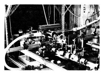
Bild 1 zeigt einen Versuchsaufbau der beschriebenen Messeinrichtung im Brown-Boveri-Forschungszentrum. Der Strömungskanal in Bildmitte besteht aus einem Glasrohr, erkennbar durch zwei dicke Plastikschläuche an beiden Enden. In Bildmitte erhöht befindet sich der Gaslaser, am Ende der optischen Bank (rechter unterer Bildrand) der Photodetektor. Zur Isolation gegen Gebäudevibrationen ruht der gesamte optische Aufbau auf einer federnd gelagerten, massiven Steinplatte.
