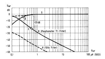
NF-Nutz- und Störpegel in Funktion des HF-Pegels für einen typischen PM-Sprechfunkempfänger (HF-Bandbreite: 17 kHz, NF-Bandbreite: 3000 Hz bzw. 10 Hz, Modulationsfre-
