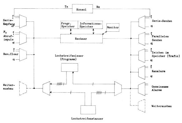
Fig. 3 Blockschema Dataflex-ELSTOR Anzahl Eingänge: 58 Anzahl Ausgänge: 147
