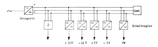
Fig. 7 Aufbau der Speisung
