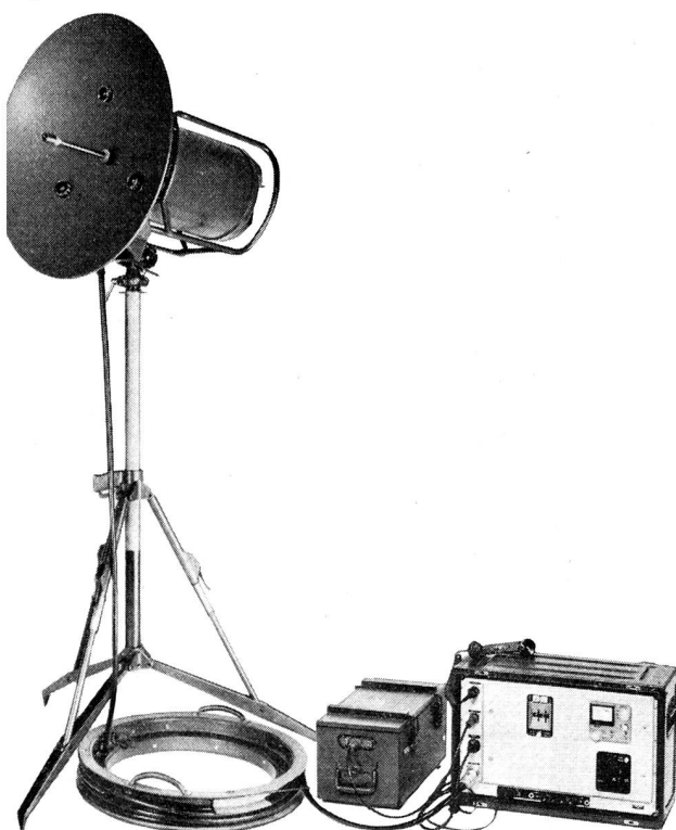
Fig. 1 Richtstrahlstation R-902, betriebsfertig aufgestellt Links: Sende-Empfangsgerät auf Armeestativ Mitte: Speiseakkumulator 24 V Rechts: Bedienungsgerät, geöffnet. Mikrorel für Dienstka- nalbesprechung angeschaltet. Mitte oben Kanalwahlschal- ter, rechts Überwachung mit Dienstkanal und Netzteil-Part.
