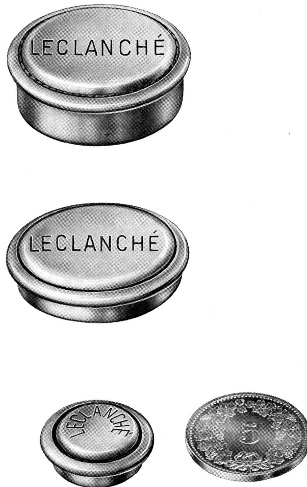
Fig. 11 Leclanché-Gasdichte Stahllakkumulatoren (Ni-Cd) in Miniaturausführung, «Knopfzellen», von 20–1000 mAh (zylindrische Zellen für 0,15–10,0 Ah), für Radio und Fernsprechanlagen, Messinstrumente, medizin. Geräte, Taschenlampen, Spielzeug, Transistorradios usw.
