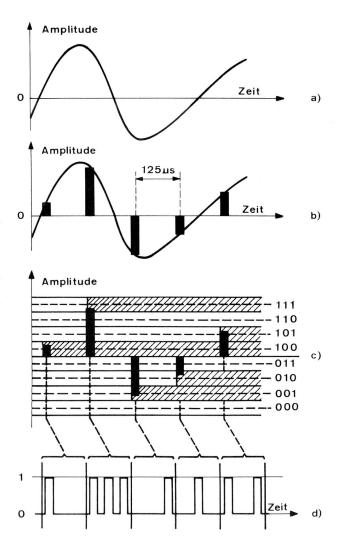
Fig. 1 Prinzip der Puls-Code-Modulation
