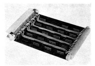
Fig. 3b PCM-Einschub (steckbare Einheit) in integrierter Technik
