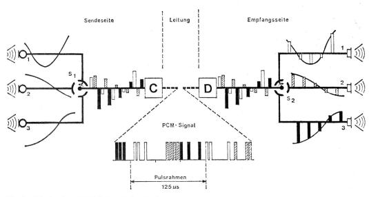
Fig. 2 Prinzip eines PCM-Zeitmultiplex-Systems
