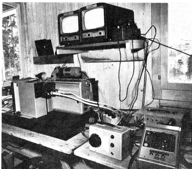
Fig. 4 Ausrüstung zum Einblenden der Zeitmessung (Rennzeit) im Fernseh-Regieraum
