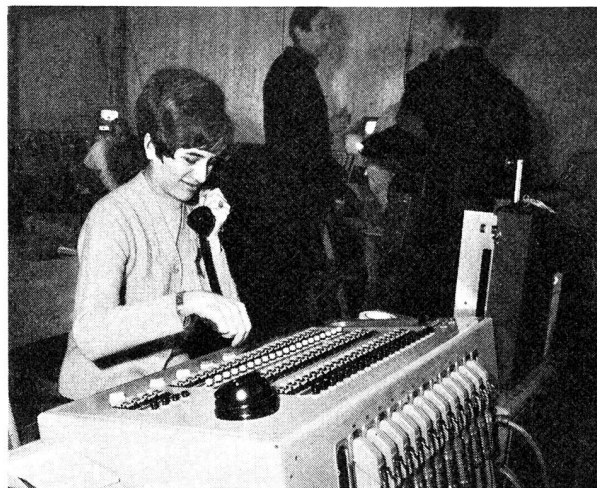
Fig. 2 Fernsehübermittlungszentrum, Bedienungspult für internationale Studio- und Reportageleitungen
