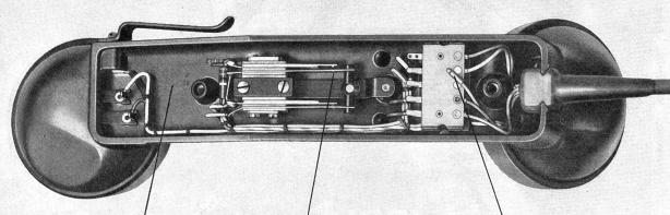
Raum für zusätzliche Schaltelemente Federsatz mit Platinkontakten Adern an der Anschlusschnur sind steckbar aus Goldkontakten
