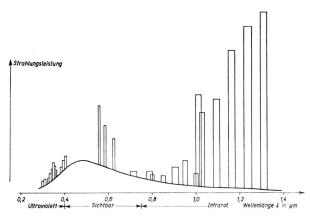
Fig. 2 Spektrale Zusammensetzung der Resthelligkeit
