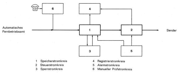
Fig. 1 Blockschema der neuen Autorufzentrale
