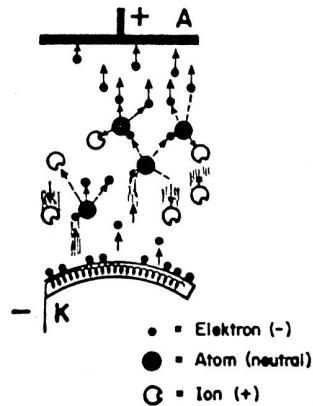
Schematische Darstellung einer beheizten Gasentladungs-röhre. Von der Glühkathode K werden Elektronen emittiert. Sie kollidieren mit den Gasatomen des Füllgases (z. B. Xenon). Bei diesen heftigen Zusammenstössen schlagen sie aus diesen die Hüllelektronen heraus, welche die Primärelektronen auf diese Weise lawinenartig vermehren. Die Elektronen fliegen als kräftiger Strom zur + Anode A, die positiv gewordene Atomreste (Ionen) zur negativen Kathode K.
