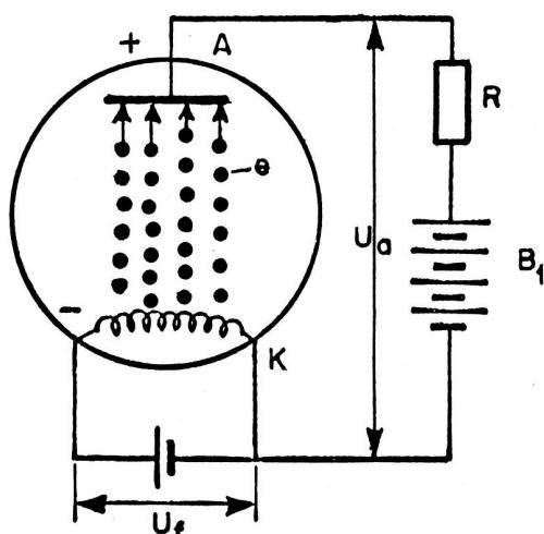
Schematische Darstellung einer Glühkathoden-Gleichrichter-Röhre. Die von der beheizten Kathode K emittierten Elektronen e werden von der auf + Potential ( $U_a$ ) liegenden Anode A angesaugt und durchfliessen als elektrischen Leistungsstrom i den äusseren Widerstand R.
