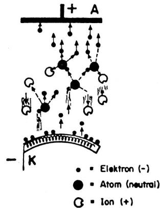
Schematische Darstellung einer beheizten Gasentladungs-röhre. Von der Glühkathode K werden Elektronen emittiert. Sie kollidieren mit den Gasatomen des Füllgases (z. B. Xenon). Bei diesen heftigen Zusammenstössen schlagen sie aus diesen die Hüllelektronen heraus, welche die Primärelektronen auf diese Weise lawinenartig vermehren. Die Elektronen fliegen als kräftiger Strom zur + Anode A, die positiv gewordenen Atomreste (Ionen) zur negativen Kathode K.
