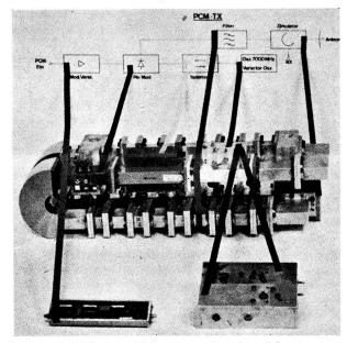
Fig. 19 PCM-Richtstrahlausrüstung, Ansicht auf Sendeteil
