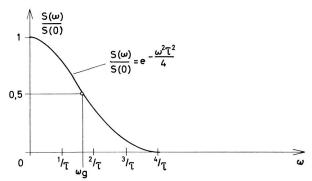
Fig. 12 Spektrum des Gauss'schen Impulses
