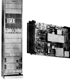
Fig. 17 PCM-Endausrüstung (links) und Kanaleinheit (rechts)
