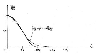
Fig. 16 cos<sup>2</sup>-Verlauf des Spektrums
