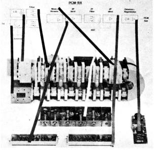
Fig. 20 PCM-Richtstrahlausrüstung, Ansicht auf Empfangsteil
