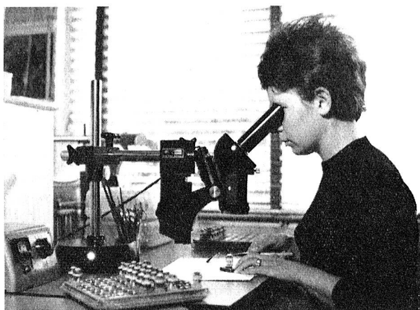
Laufende Kontrolle von Kaltkathodenröhren mit dem Mikroskop.
