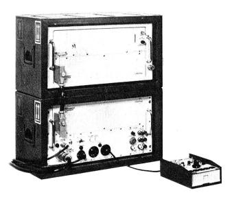
Das Gretag-System TC-534 umfasst automatische Uebermittlungs- und Chiffriergeräte für die Geheimübertragung von Fernschreibnachrichten über Funk-, Telex- oder Telefonverbindungen.
