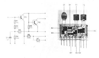
Fig. 2 Das Schaltbild und die Bauelementeauslegung des neuesten O2F — NF-Vorverstärkermoduls zeigen, wie Widerstände, Leiter, Kondensatoren und Isolierungen angeordnet sind. Der  $10~\mu F$  Elektrolytkondensator C1 ist, ebenso wie die beiden Transistoren, als diskretes Element aufgelötet. Der fertige Modul ist in «Araldite» (Epoxyharz) eingegossen.
