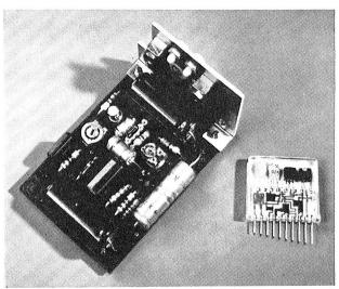
Fig. 3 Grössenvergleich zwischen einem in herkömmlicher Weise gefertigten NF-Vorverstärkerbaustein und dem O2F Dickfilm Modul. Der O2F (rechts) übernimmt die Funktionen der zwischen den drei grossen Elektrolytkondensatoren liegenden Komponenten des konventionellen Schaltkreises.
