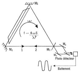
Fig. 11: Schéma d'un gyromètre à laser
