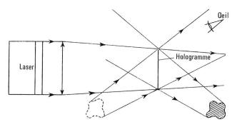
Fig. 15: Restitution d'un hologramme
