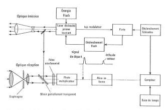
Fig. 13: Schéma bloc d'un télémètre laser
