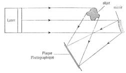
Fig. 14: Enregistrement d'un hologramme
