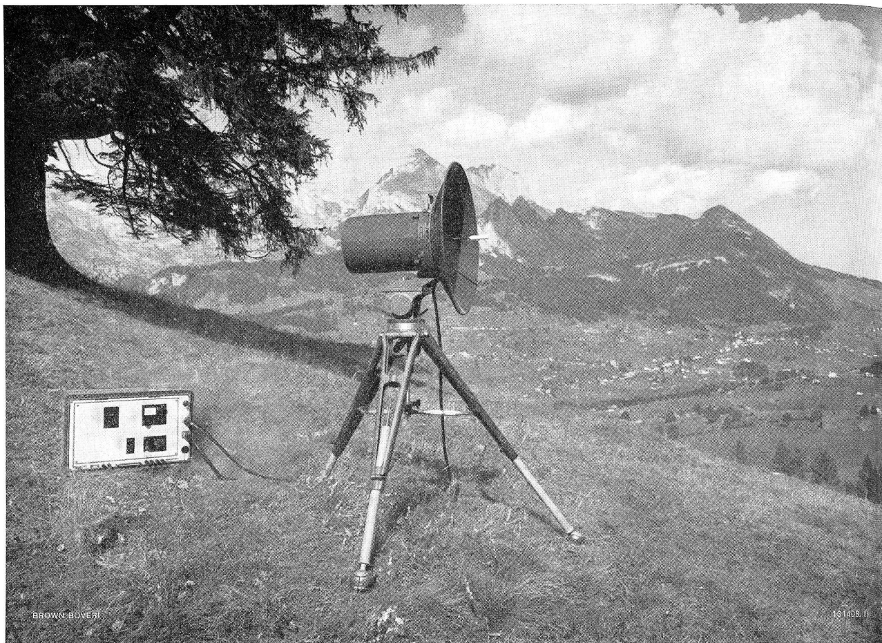
Modernes Richtstrahlende-/Empfangsgerät für Mehrkanalübertragung im Frequenzband 6400...8000 MHz
