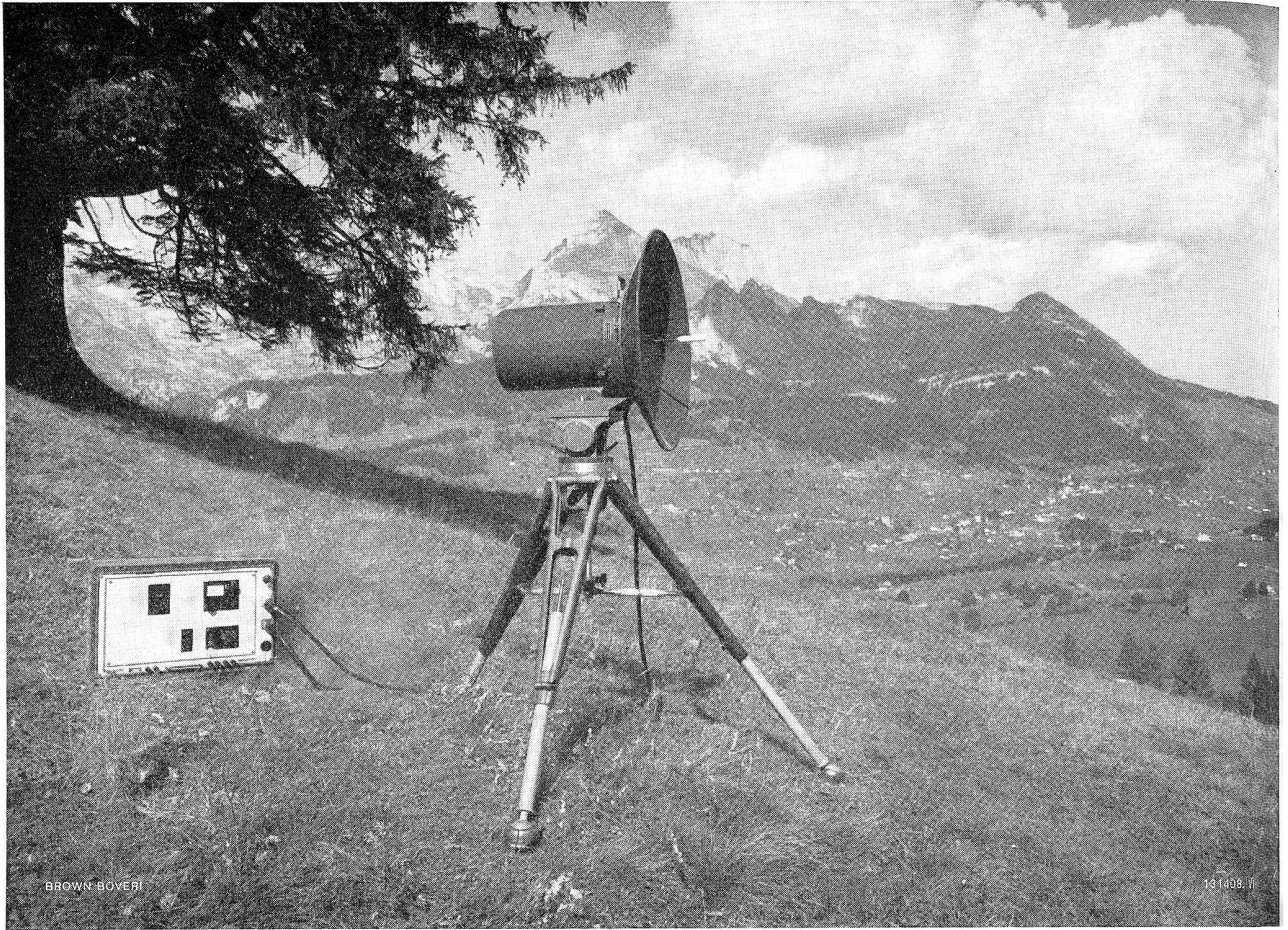
Modernes Richtstrahlende-/Empfangsgerät für Mehrkanalübertragung im Frequenzband 6400...8000 MHz
