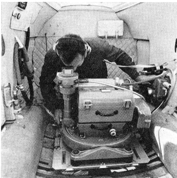
Automatische Reihenkamera WILD RC8, die in ein Flugzeug eingebaut wird. Sie dient hier zur photogrammetrischen Aufnahme eines Geländes im Rahmen einer Landesvermessung und Kartierung.
