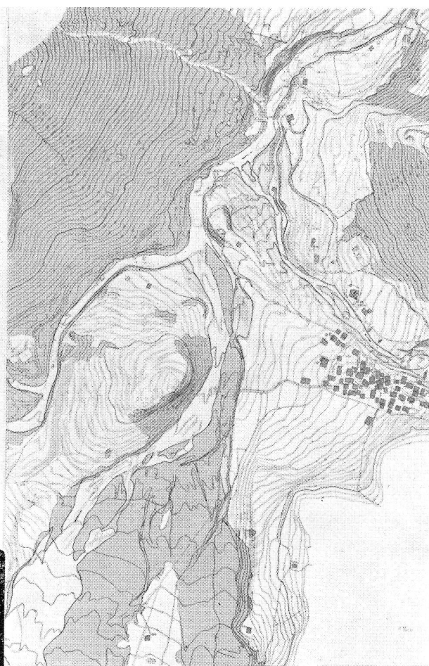
Originalaufnahme mit der automatischen Fliegerkammer Wild RC 7a, Objektiv: Aviogon f=100 mm, Flughöhe 1200 m über Grund, Maßstab 1:2000
