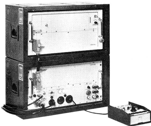
Das Gretag-System TC-534 umfasst automatische Uebermittlungs- und Chiffriergeräte für die Geheimübertragung von Fernschreibnachrichten über Funk-, Telex- oder Telefonverbindungen.
