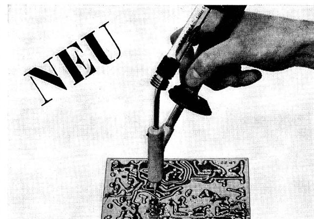
Grosse Zeiter sparnis und Arbeitserleichterung mit ZEVA-Vakuum-Lötkolben beim Auslöten von Bauteilen auf gedruckten Schaltungen. Keine thermische oder mechanische Beschädigung der Bauteile oder Platten. Bohrungen oder Lötosen bleiben geöffnet. Modelle für Werkstatt, Labor oder Reparaturservice. Verlangen Sie bitte unsere Unterlagen.
