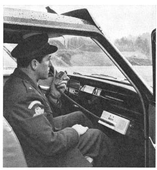
Abb. 9. Bei den in den Fahrzeugen eingebauten Funkanlagen handelt es sich um Geräte der englischen Firma PYE. Die Geräte lassen sich an einem Drehknopf auf 3 Kanäle umschalten. Notfalls sind sie mit wenigen Handgriffen auswechselbar.
