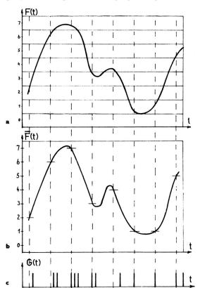
Fig. 4. Pulsecodemodulation eines Signales.
