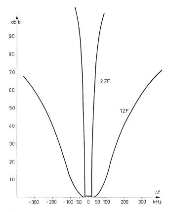
Fig. 10: Beispiele von Selektionskurven für die erste und die zweite Zwischenfrequenz bei 50 kHz Kanalabstand. Die 1. ZF beträgt in diesem Beispiel 10,7 MHz und die zweite 471 kHz.
