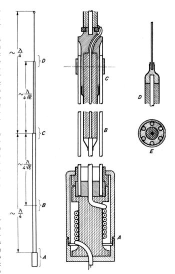
Fig. 11: Biegsame Koaxial-Dipol-Antenne mit Sperrtopf für das 2-m-Band. Der Maßstab der halbschematischen Darstellung wurde in der Querrichtung grösser als in der Längsrichtung gewählt, weshalb die Antenne in Wirklichkeit schlanker ist als sie auf der Zeichnung erscheint. Die an der Übersichtsdarstellung links mit Buchstaben bezeichneten Abschnitte sind rechts vergrössert dargestellt und mit den selben Buchstaben bezeichnet. E stellt einen Querschnitt zwischen den Bereichen A und B dar.
