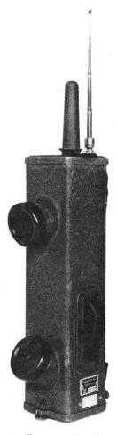
Fig. 2: Kleinfunkgerät «Fox» aus dem Jahre 1949. Frequenzbereich 3,5 bis 6 MHz. 1 Kanal, kristallgesteuert. Sendeleistung 20 mW. Empfindlichkeit 6  $\mu V.$  Amplitudenmodulation. Gewicht (inkl. Batterien) 2,5 kg.
