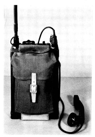
Fig. 3: Kleinfunkgerät SE 207 aus dem Jahre 1958. 86 kristallgesteuerte Kanäle im Bereich von ca. 6 m. Sendeleistung bei Batteriebetrieb 800 mW (mit fremder Spannungsquelle 3 W). Empfindlichkeit 0,5  $\mu$ V. Frequenzmodulation. Gewicht (mit Batterien) 11,3 kg.
