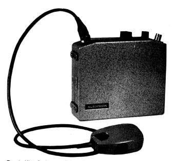
Fig. 4: Kleinfunkgerät SE 18 A aus dem Jahre 1961. 4 kristalgesteuerte Kanäle im Frequenzbereich 148 bis 174 MHz (2 m) oder 68 bis 87,5 MHz (4 m). Kanalabstand 25 oder 50 kHz. Sendeleistung 750 mW. Empfindlichkeit 0,5  $\mu$ V. Phasenmodulation. Gewicht (mit Batterie) 2,5 kg. Bestückung mit Transistoren und 2 Röhren.
