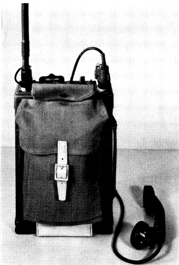
Fig. 3: Kleinfunkgerät SE 207 aus dem Jahre 1958. 86 kristallgesteuerte Kanäle im Bereich von ca. 6 m. Sendeleistung bei Batteriebetrieb 800 mW (mit fremder Spannungsquelle 3 W). Empfindlichkeit 0,5 \mu\text{V} . Frequenzmodulation. Gewicht (mit Batterien) 11,3 kg.
