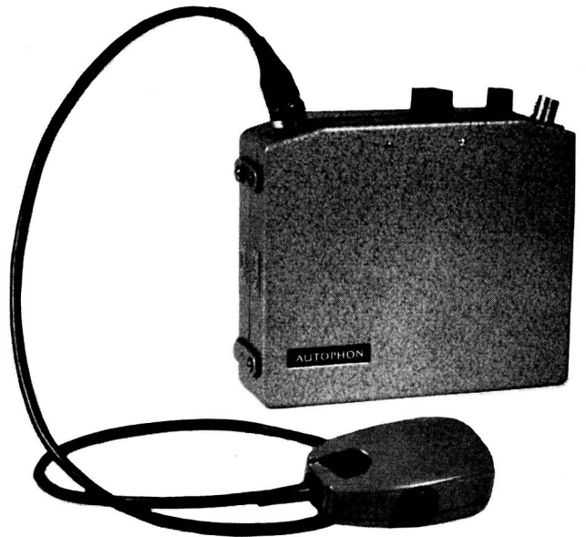
Fig. 4: Kleinfunkgerät SE 18 A aus dem Jahre 1961. 4 kristallgesteuerte Kanäle im Frequenzbereich 148 bis 174 MHz (2 m) oder 68 bis 87,5 MHz (4 m). Kanalabstand 25 oder 50 kHz. Sendeleistung 750 mW. Empfindlichkeit 0,5 \mu\text{V} . Phasenmodulation. Gewicht (mit Batterie) 2,5 kg. Bestückung mit Transistoren und 2 Röhren.
