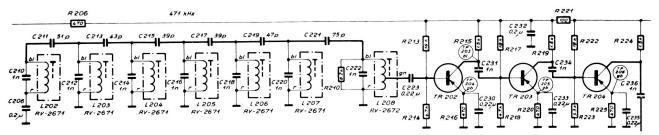
Fig. 9: Schema des Filters und Verstärkers für die zweite Zwischenfrequenz eines Funkgerätes. Durch Konzentration der Kreise einerseits und der Verstärkerstufen anderseits kann
