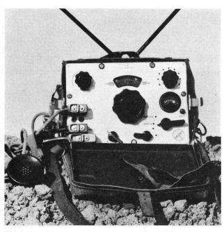
Fig. 1: Kleinfunkgerät «Max» aus dem Jahre 1945. Dazu gehört noch ein Hand- oder Tretgenerator. Frequenzbereich 58,4 bis 68,4 MHz, kontinuierlich einstellbar. Sendeleistung 100 mW. Empfindlichkeit 20  $\mu V.$  Amplitudenmodulation. Gewicht (ohne Speiseteil) 3,5 kg, mit sämtlichem Zubehör 12,35 kg.
