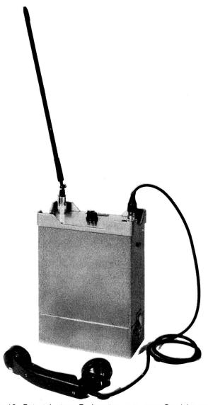
Fig. 13: Beispiel eines Funkgerätes mit einer Sendeleistung von 6 W und einem Gewicht von 5,5 kg, welches unter Verwendung der Bauteile des auf Fig. 4 gezeigten Gerätes entwickelt wurde und im übrigen die gleichen Eigenschaften aufweist. Besonders für den Gebrauch auf Motorrädern geeignet.
