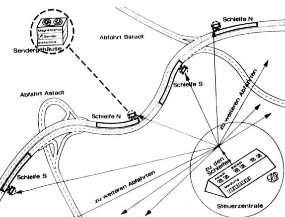
Schematische Darstellung eines Autobahnstreckenabschnittes mit den technischen Anlagen des Verkehrsfunks. Von einer Steuerzentrale aus werden durch Impulse die auf Tonband gespeicherten Verkehrsberichte für die Autofahrer an den Streckenabschnitten vor den jeweiligen Autobahnabschnitten ausgelöst. Die Nachrichten werden von einem kleinen Sender über eine ca. 3 km lange sogenannte Schleife ausgestrahlt.
