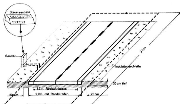
Schematische Darstellung einer Schleifenverlegung. Von einem Sender aus wird ein dünnes Spezialkabel zu einer Induktionsschleife ausgelegt, die jeweils ca. 3 km an beiden Seiten längs der Fahrbahn entlangläuft und die Fahrbahn in einer der Trenn- oder Stoßfugen überquert.
