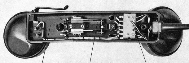
Raum für zusätzliche Schaltelemente Federsatz mit Platinkontakten Adern an der Anschlusschnur sind steckbar aus Goldkontakten
