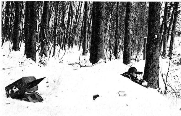
MOSQUITO-Schütze mit einsatzbereiter Lenkwaffe. Am Lenkgerät können gleichzeitig sechs Lenkwaffen angeschlossen werden. Der Abstand zwischen Schütze und Lenkwaffen kann bis zu 100 m betragen, was eine taktisch günstige Aufstellung ermöglicht. Der Behälter ist vorne und hinten durch eine Folie abgeschlossen, so dass die Lenkwaffe bis zum Start auch im Winter vollständig gegen Witterungseinflüsse geschützt ist.
