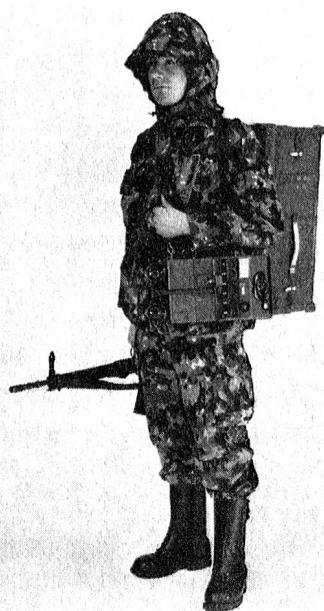
MOSQUITO-Schütze mit vollständigem Waffensystem zur Bekämpfung von Panzern auf Distanzen zwischen 400 und 2400 m. Der hier am Rücken getragene Startbehälter enthält eine Lenkwaffe MOSQUITO 64 und die Verbindungskabel (2 x 50 m) zum Lenkgerät. An einem Schulterriemen trägt der Schütze das Lenkgerät, an welchem gleichzeitig sechs Lenkwaffen angeschlossen werden können.
