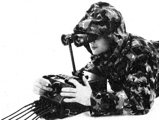
MOSQUITO-Schütze am Lenkgerät, an welchem sechs Lenkwaffen angeschlossen sind. Der Schütze wählt die zu startende Lenkwaffe durch Betätigung der Wahltafel und startet die vorgewählte Lenkwaffe durch Druck auf die Starttaste (Bild). Mittels eines Lenknüppels wird die Lenkwaffe nach dem Zieldeckungsverfahren ins Ziel gebracht.
