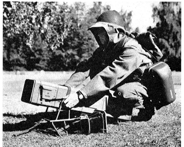
Das Einschalten des Systems erfolgt durch einige einfache Handgriffe in etwa 30 s, aus der Bewegung bis zum Schuss.
