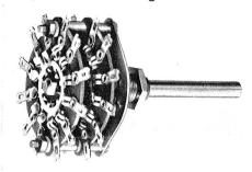
Schaltebenen aus Keramik-Baustoff oder tropenfestem Hartpapier (Klasse IV). Selbstreinigende Messerkontakte. Auf Wunsch: Silber-, Silber-Palladiumoder Gold-Nickel-Kontakte.
