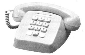
Abb. 4. Telephon-Tischapparat mit Tastatur zur Eingabe der Rufnummern (Tastwahlstation).
