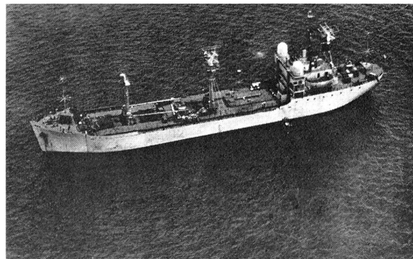
Das Bahnverfolgungsschiff «Rose Knot» dient als mobile Telemetriestation für Versuche mit bemannten Raumfahrzeugen. Seine Ausrüstung erlaubt Empfang und Befehlsübertragung.
