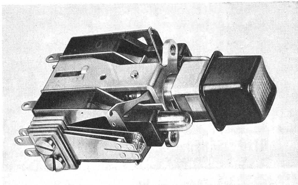
**erlaubt den Aufbau der ALBIS - Chefstationen kompakt zu gestalten, da die Anzeigeorgane wie z. B. „Anruf“, „Besetzt“, „Halten“ usw. in der Taste selbst eingebaut sind. Die Anzeige des jeweiligen Betriebszustandes direkt mit der Taste bedeutet zudem noch einfachere und übersichtlichere Bedienung.**
