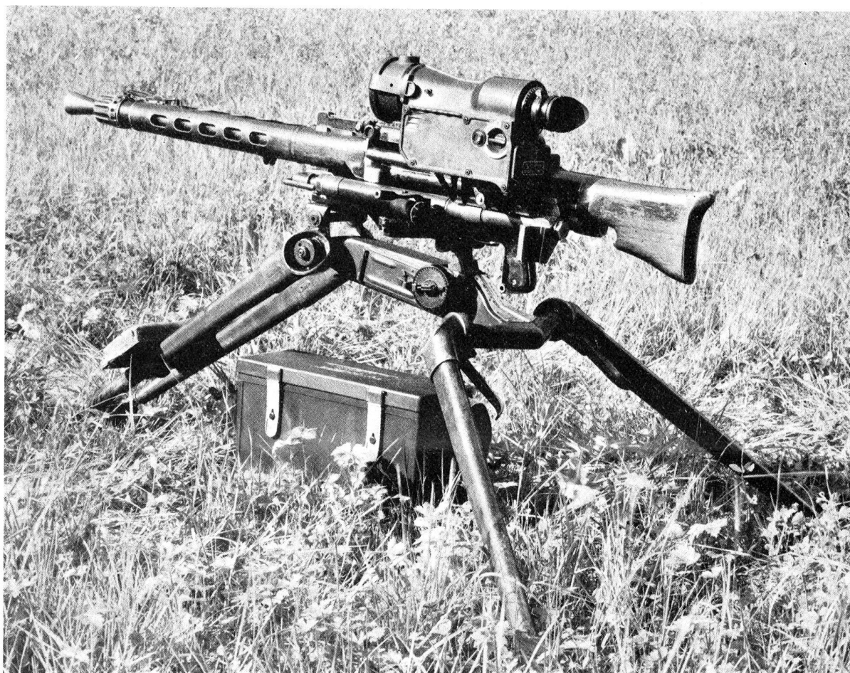
Abb. 18 IR-Zielgerät für Mg. 51. Es unterhält nur den Strahlenempfänger und gelangt mit dem auf dem Titelbild der Nr. 1/1963 gezeigten Gerät zusammen zum Einsatz. Die beiden Standorte sind in der Regel etwas getrennt.
