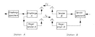
Abb. 2. Modifizierte Janet-Anlage, bei der die beiden Übertragungsrichtungen voneinander unabhängig sind
