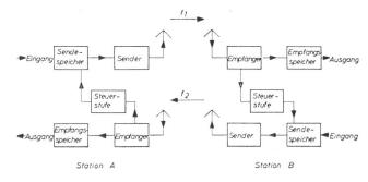
Abb. 1. Blockschaltung einer Janet-Anlage für meteoritische Streustrahlverbindung
