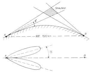
Abb. 4. Richtcharakteristik der Sende- und Empfangsantennen
