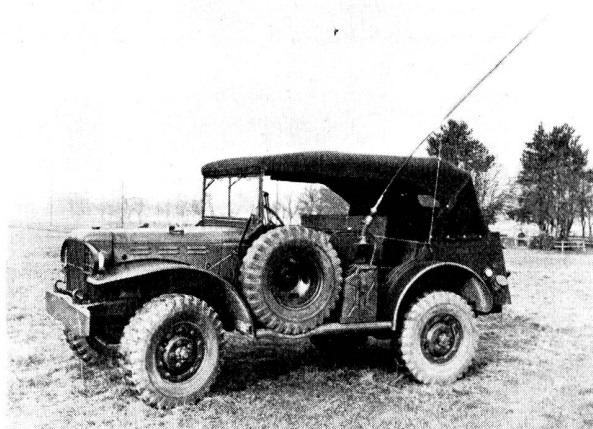
Abb. 45. Funkstation Fix in «Kommando Car» eingebaut, 10 Kanäle, kristallgesteuert.
