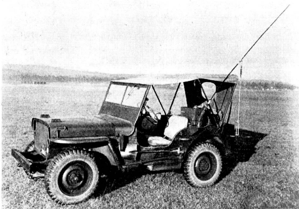
Abb. 44. Funkstation «Rex» in Jeep eingebaut, 1 Kanal, kristallgesteuert.
