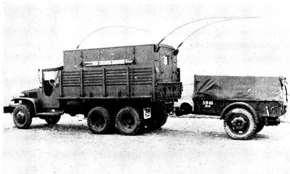
Abb. 41. Funkstation SM 46 auf geländegängigem Lastwagen montiert.
