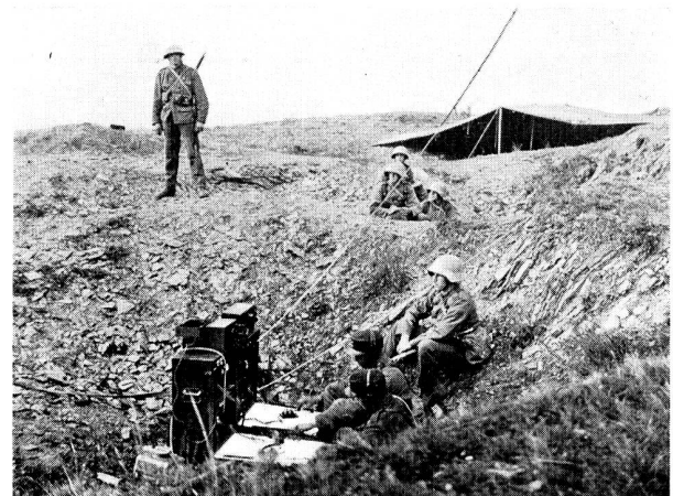
Abb. 34. Tragbare schwere Funkstation (TS) in Stellung.
