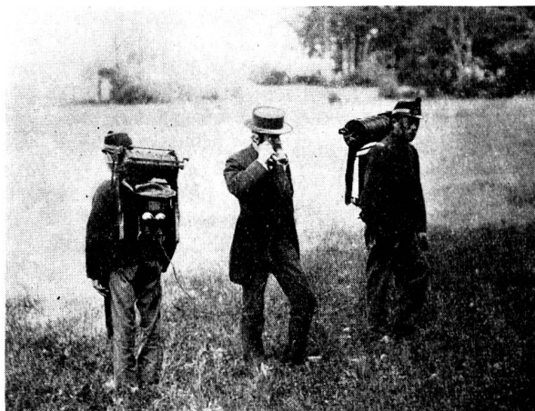
Abb. 4. Versuche mit einer der ersten Militär-Telephonstationen
