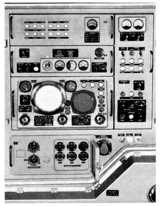
Fig. 13. Radaranzeige- und -bedienungsteil zu Feuerleitradar «Superfledermaus».
