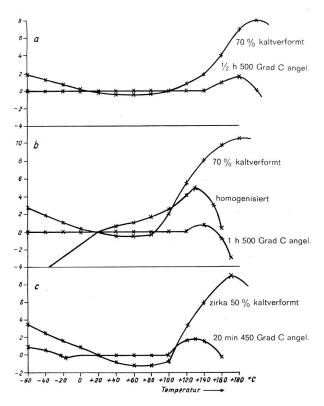
Fig. 5. Temperaturgang des Elastizitätsmoduls bei (a) Thermalast 4009, (b) Thermalast 5409, (c) Ni-Span C.
