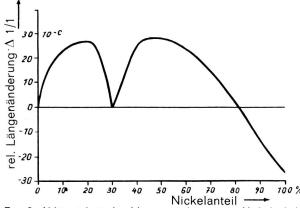
Fig. 6. Abhängigkeit der Magnetostriktion vom Nickelgehalt einer Nickel-Eisen-Legierung.
