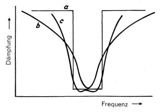
Fig. 1. Dämpfungskurven (a) eines idealen Filters, (b) eines üblichen Schwingkreises und (c) einer Schwingkreiskombination.
