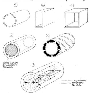
Hohlleiter mit rundem (a), rechteckigem (b) und quadratischem (c) Querschnitt; zur Unterdrückung unerwünschter Wellentypen mit dielektrischem Material bedeckt (d) oder aus Wendeln aufgebaut (e); Feldlinien der H<sub>01</sub>-Welle im Hohlleiter mit rundem Querschnitt (f).
