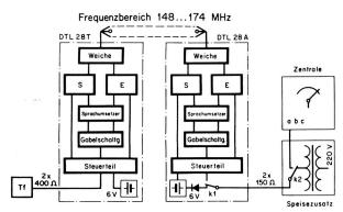
Fig. 2. Blockschemata der Anlageteile der drahtlosen Telephonanlage für Fixverbindungen der Autophon AG. S = Sender, E = Empfänger.
