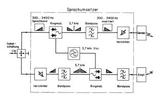
Fig. 7. Blockschema des Sprachumsetzers. Die Sprechsignale werden in einer aus der Trägerfrequenztechnick bekannten Art mittels eines Hilfsträgers von 3,7 kHz invertiert.
