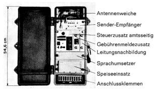
Fig. 4. Ansicht des amtsseitigen Anlageteils DTL 28 A einer drahtlosen Teilnehmeranlage für Fixverbindungen der Autophon AG. Interessant ist der Umstand, dass Sender und Empfänger volumenmässig nur einen kleinen Bruchteil der Gesamtanlage ausmachen. Das Gehäuse aus Gusseisen gestattet die Aufstellung der Anlage im Freien.
