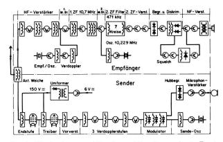
Fig. 3. Blockschema von Sender und Empfänger der in Fig. 2 dargestellten Anlage. Ausser Treiber- und Endstufe sind sämtliche Stufen mit Transistoren ausgerüstet, wodurch im Bereitschaftszustand nur 0,25 W und im Betriebszustand 7 W Energie verbraucht wird.
