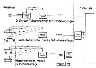
Fig. 1. Zusammenstellung der wichtigsten drahtlosen Teilnehmeranlagen mit Sprechmöglichkeit.
