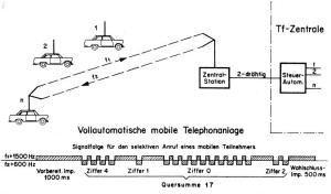
Fig. 8. Schematische Darstellung der drahtlos übertragenen Signale zum selektiven Aufruf einer mobilen Station als Gegensatz zu Fig. 6. Da hier andere Erfordernisse vorliegen, mussten auch andere Lösungen mit Signalübermittlung im Sprachfrequenzgebiet angewendet werden.
