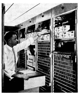
Prüfung der zentralen Kontrolleinrichtung, die das gesamte elektronische Amt überwacht und steuert.
