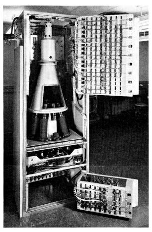
Gestell mit dem als Dauerspeicher eingesetzten «flying-spot store». In der Pyramidenspitze liegt die Braunsche Röhre. Der von ihr erzeugte und blitzschnell auf jede gewünschte Stelle des Bildschirmes gelenkte Lichtpunkt wird von mehreren Linsensystemen auf Photoplatten geworfen, welche die eigentliche Information enthalten.
