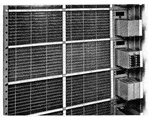
Fig. 2. Schaltfelder eines Herkonrelais-Zuordners mit Auswertegruppen.
