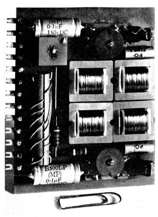
Fig. 1. Baugruppe der vollelektronischen Vermittlung mit zwei Ferroresonanz-Flip-Flop-Schaltungen.
