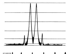
Fig. 9: Bildaufnahme des HF-Spektrums Messung der Modulationsprodukte nach der Zweitonmethode. In der Mitte des Bildes die 2 Referenzfrequenzen, links und rechts davon die Modulationsprodukte 3. Ordnung. Abstand zwischen einzelnen waagrechten Linien: 10 db. Zu unterst Frequenzmarkierungsimpulse von 1 kHz
