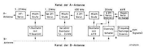
Fig. 14: Hochselektiver R-6-Empfänger für Zweifach-Empfang
