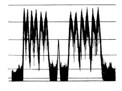
Fig. 10: Bildaufnahme des HF-Spektrums im normalen Betriebszustand. In der Bildmitte der Restträger, links und rechts davon je 3 unabhängige frequenzmodulierte 180-Baud-Zeitmultiplex-Kanäle
