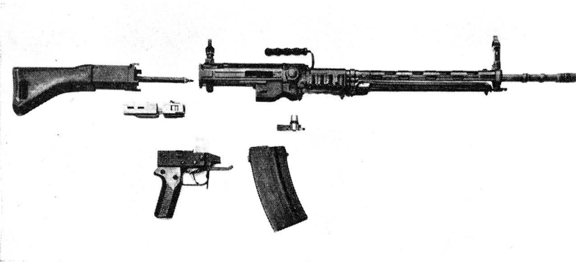
Fig. 6: Sturmgewehr in die Hauptbestandteile zerlegt
