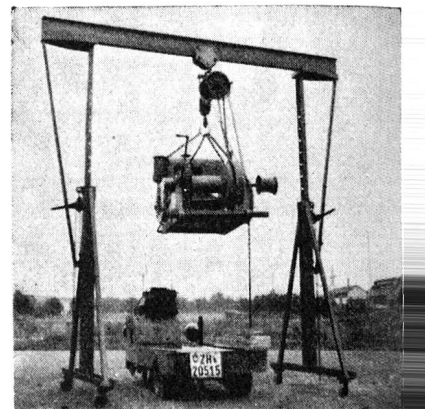
Ausführung «A» (Fig. oben) ist besonders geeignet für Arbeiten in hohen und niedrigen Räumen und um Tore mit oder ohne Last zu passieren, ohne zerlegt zu werden. — Prospekt Nr. 15 254.
