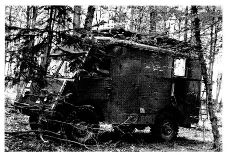
Zum Einsatz bei den Telegraphenkompagnien ist ein neuer Zentralenwagen entwickelt worden, der auf einem leichten Geländelastwagen montiert, die alten und nicht geländegängigen Zentralenwagen und -anhänger ersetzen soll. Oben: Der Zentralenwagen Mod. 55 im Gelände.
