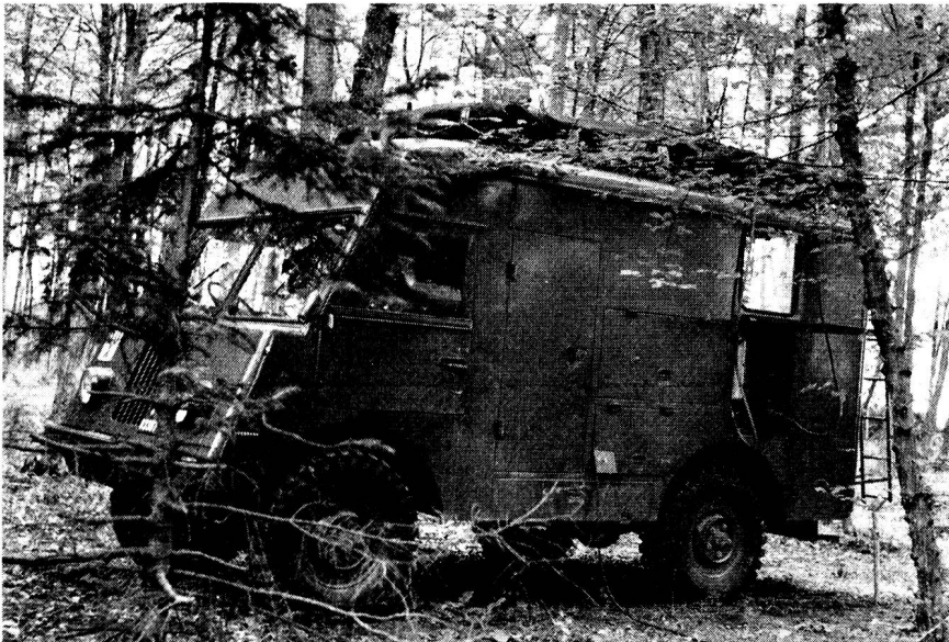
Zum Einsatz bei den Telegraphenkompanien ist ein neuer Zentralenwagen entwickelt worden, der auf einem leichten Geländelastwagen montiert, die alten und nicht geländegängigen Zentralenwagen und -anhänger ersetzen soll. Oben: Der Zentralenwagen Mod. 55 im Gelände.
