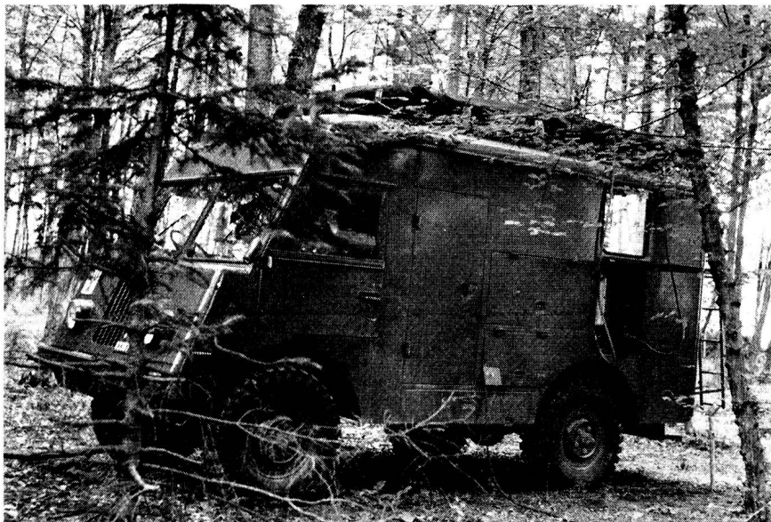
Zum Einsatz bei den Telegraphenkompagnien ist ein neuer Zentrallenwagen entwickelt worden, der auf einem leichten Geländelastwagen montiert, die alten und nicht geländegängigen Zentrallenwagen und -anhänger ersetzen soll. Oben: Der Zentrallenwagen Mod. 55 im Gelände.
