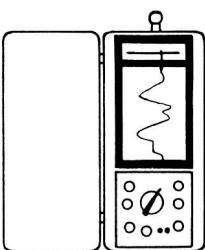
An die gleichen Meßbuchsen kann auch ein geeigneter Linienschreiber angeschlossen werden, der die Mühe erspart, Meßwerte zu notieren, und der über Stunden oder auch Tage die Stromschwankungen aufzeichnet.
