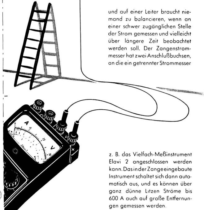
z. B. das Vielfach-Meßinstrument Elavi 2 angeschlossen werden kann. Das in der Zange eingegebene Instrument schaltet sich dann automatisch aus, und es können über ganz dünne Litzen Ströme bis 600 A auch auf große Entfernung gemessen werden.
