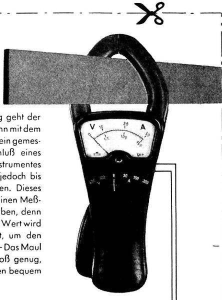
Bis 300 A Endausschlag geht der größte Meßbereich, wenn mit dem Zangenstrommesser allein gemessen wird. Beim Anschluß eines getrennten Anzeigegerätes kann der Meßbereich jedoch bis 600 A erweitert werden. Dieses Instrument muß dann einen Meßbereich von 60 mA haben, denn der von ihm angezeigte Wert wird mit 10000 vervielfacht, um den Meßstrom zu erhalten. — Das Maul der Stromzange ist groß genug, um auch 600 A-Schienen bequem umfassen zu können.
