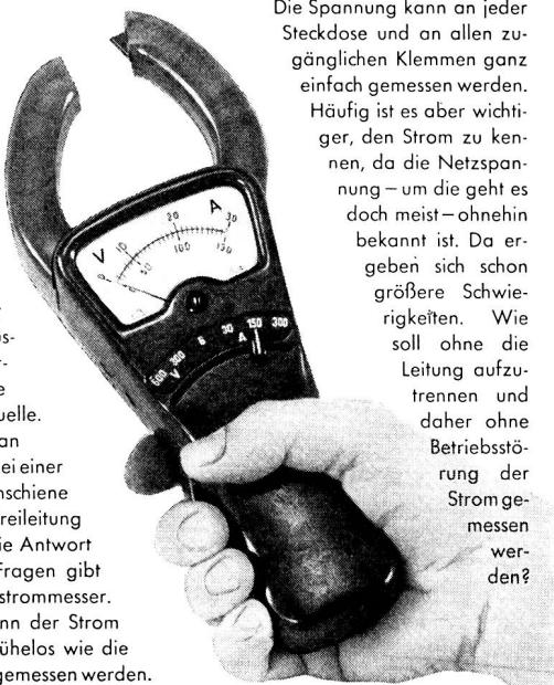
Behelfsmäßige Leitungen führen leicht zu Kurzschlüssen und bergen manche Gefahrenquelle. Was soll man schließlich bei einer 300 A-Stromschiene oder einer Freileitung machen? Die Antwort auf diese Fragen gibt der Zangenstrommesser. Mit ihm kann der Strom genauso mühelos wie die Spannung gemessen werden.
